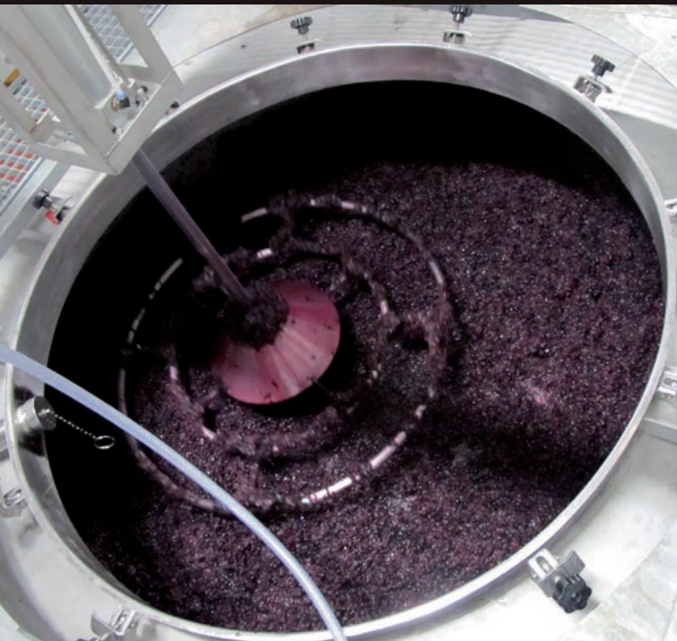
Rampe de Robots pigeurs au-dessus de chacune des cuves. ▼ Line of punch-down robots above each one of the vats.
